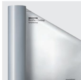
Dampfbremse aus PE-Folie - dauerhaft diffusionshemmend im Sommer und im Winter, mit einem sd-Wert von 100m. Ermöglicht Konstruktionsaufbauten gemäß DIN 4108-3. Überlappungen und
